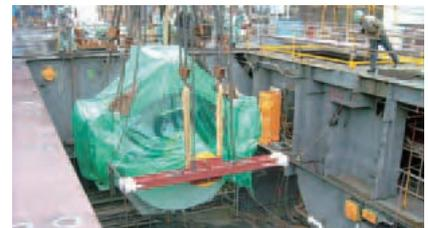
電気推進装置用電動機 艦装作業風景
