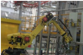
塗装装置へのハッチドア投入
