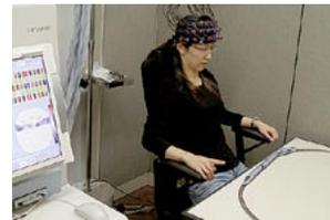
考えただけで鉄道模型を動かすブレインマシンインターフェイス
