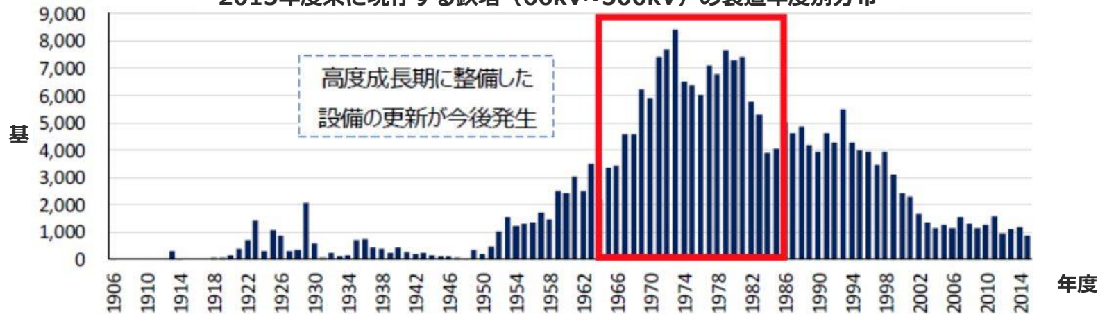
2015年度末に現存する鉄塔（66kV～500kV）の製造年度別分布
