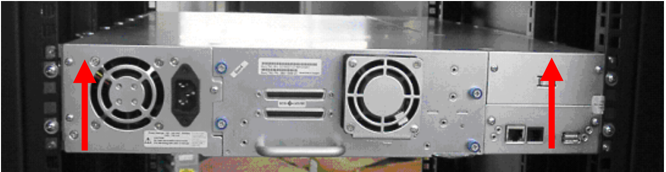
ラック搭載確認図 ( L 1 / 2 4 テープライブラリの例 )
