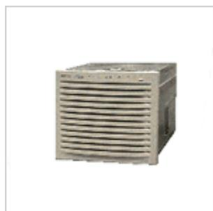
将来提供されるプロセッサ(PA-RISC)にも対応できるアーキテクチャを採用した新ミッドレンジサーバです。アーキテクチャは、低遅延を実現したメモリーコントローラを中心に、最大バンド幅2.13Gバイト/秒のバス2本と、最大バンド幅2.1Gバイト/秒のメモリーバス4本が、それぞれ独立して接続され、システムの大規模化や、将来の拡張にも配慮されています。モデルrp7400では、プロセッサに最新鋭のPA-8700/PA-8600を採用し、最大構成で8プロセッサまで拡張することができます。各プロセッサは、バスコンバータを介してシステムバスに接続されるため、プロセッサの増加に対応した性能向上が図れます。
