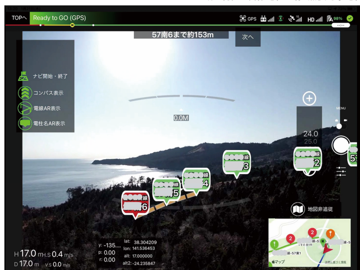
ドローンと電柱位置情報をリンクさせたナビゲーションアプリ画面例
