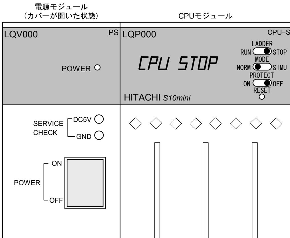
図5-2 電源スイッチの位置とCPUモジュールのスイッチ設定
