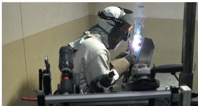
電気溶接の訓練に集中する選手。電気溶接は金属同士を電気アーク放電によって生じる約5千～2万℃の高熱を利用して加熱・熔融して接合する技術。さまざまな方法があり、競技では指示された施工法を正しく読み取る図面読解力をはじめ、溶接の仕上りの美しさ、寸法の精度、X線による精密検査、作品の強度など、溶接に関するあらゆる技能や技術、知識が問われる。
