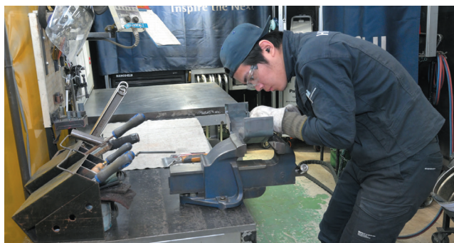
技能五輪に向けて構造物鉄工の訓練に励む選手。構造物鉄工は、さまざまな形状の鋼材を組み合わせることで構造物をつくる技能。切断、曲げ加工、組み立てなどの高度な加工や接合技術を用いる。競技では完成品の高い寸法精度、切断面・溶接箇所の仕上りの技術、スライド部の滑らかさ、全体としての美しさなどが要求される。
