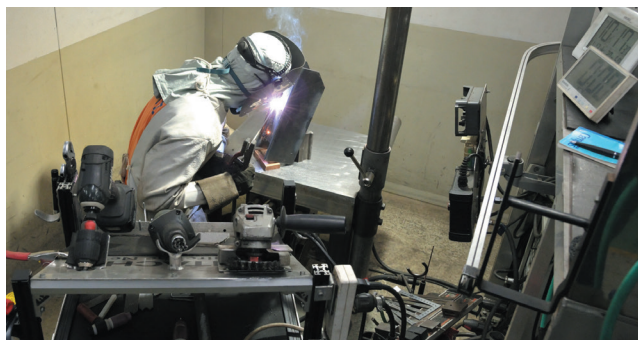
電気溶接の訓練に集中する選手。電気溶接は金属同士を電気アーク放電によって生じる約5千～2万℃の高熱を利用して加熱・熔融して接合する技術。さまざまな方法があり、競技では指示された施工法を正しく読み取る図面読解力をはじめ、溶接の仕上りの美しさ、寸法の精度、X線による精密検査、作品の強度など、溶接に関するあらゆる技能や技術、知識が問われる。
