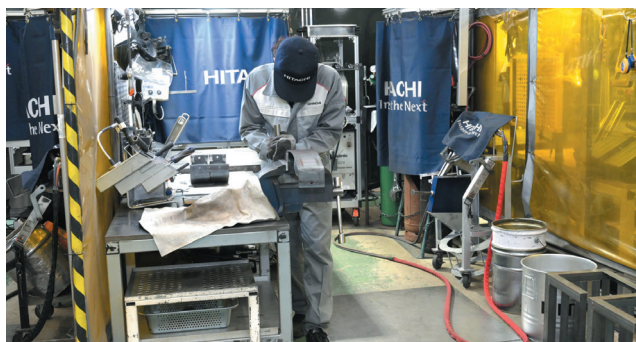
技能五輪に向けて構造物鉄工の訓練に励む選手。構造物鉄工は、さまざまな形状の鋼材を組み合わせることで構造物をつくる技能。切断、曲げ加工、組み立てなどの高度な加工や接合技術を用いる。競技では完成品の高い寸法精度、切断面・溶接箇所の仕上りの技術、スライド部の滑らかさ、全体としての美しさなどが要求される。
