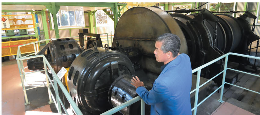
第一竖坑のケージを昇降させていた巻揚機。巨大なモーターでドラムを回転させワイヤーを巻き上げ・下げしていた。当時のまま保存、展示されている
