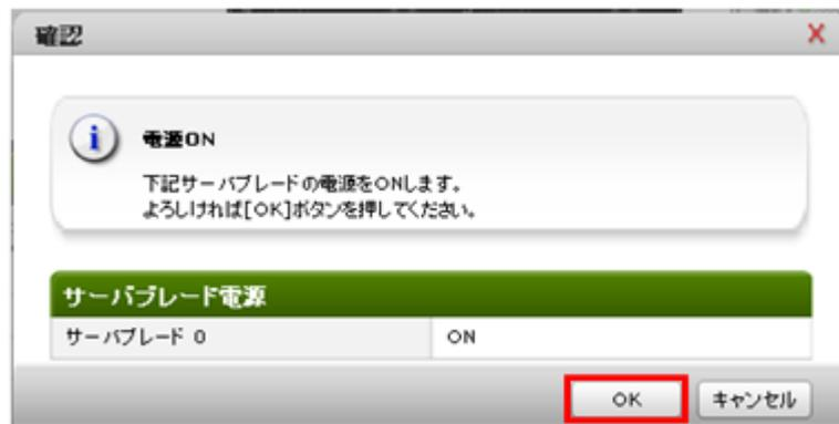
6. 選択したサーバブレードの電源が入り、OS が起動します。
