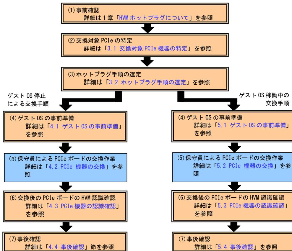
図 2 PCIe ボードの交換手順
