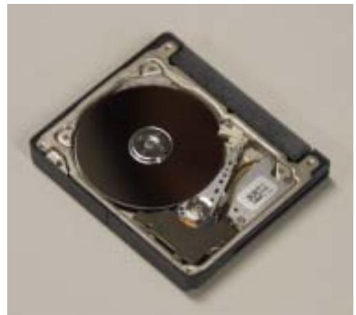
図3.3 1.0型HDD(ほぼ実寸大)
