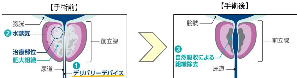
デバイスを挿入し103度の水蒸気を噴霧し、前立腺組織を約70度まで上昇させ組織を壊死させる
