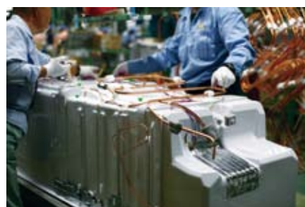
パイプの取り付け
