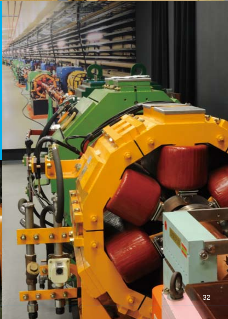
KEKB展示室に置かれている電磁石。トンネル内の写真を背景に、実際に使用する機器をそのまま展示。
