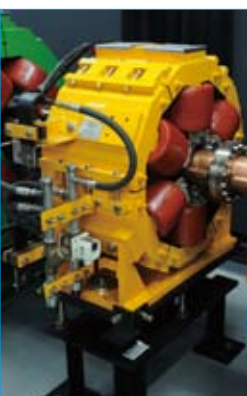
KEKBで使用されている日立の電磁石。
