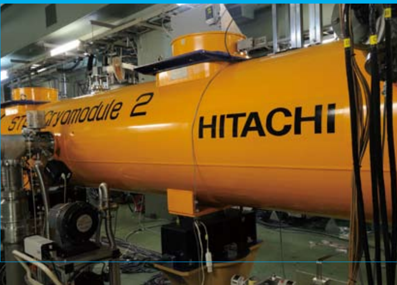
クライオスタットと呼ばれる、超伝導装置を包むジャケット部分。実際の長さは12mだが、現時点では、半分の長さで断熱性能の試験を重ねているところだ。
