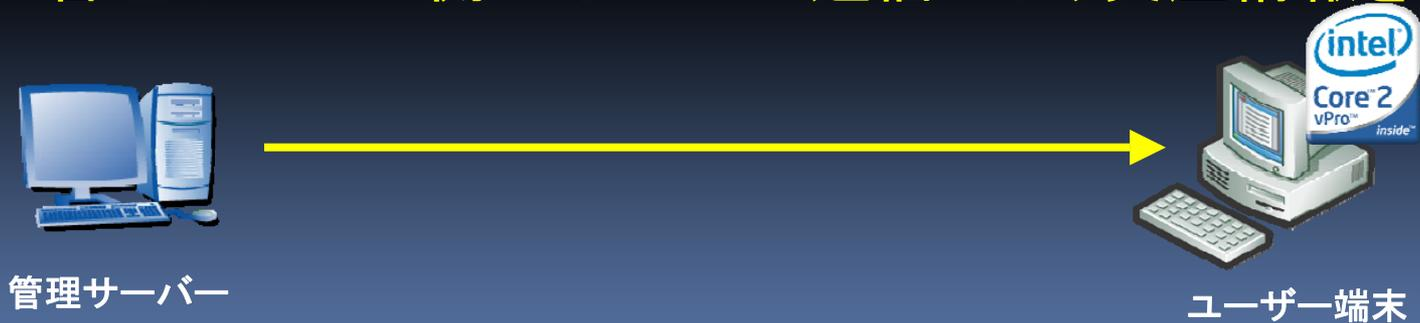
\*O.O.B通信: DC電源がオフもしくはブルースクリーンの状態においても管理サーバーからクライアント端末が制御可能な状態のこと。
