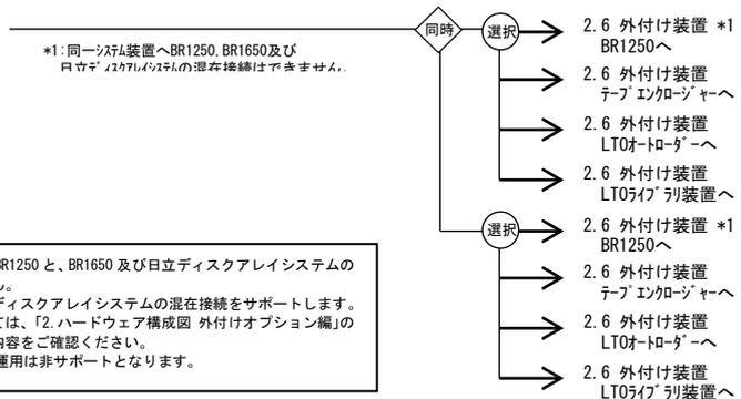
※1: 同一システム装置で BR1250 と、BR1650 及び日立ディスクアレイシステムの混在接続はできません。但し、BR1650 と日立ディスクアレイシステムの混在接続をサポートします。接続方法につきましては、「2. ハードウェア構成図 外付けオプション編」の各外付け装置の記載内容をご確認ください。
