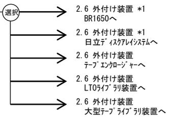
※1: 同一システム装置で BR1250 と、BR1650 及び日立ディスクアレイシステムの混在接続はできません。但し、BR1650 と日立ディスクアレイシステムの混在接続をサポートします。接続方法につきましては、「2. ハードウェア構成図 外付けオプション編」の各外付け装置の記載内容をご確認ください。
