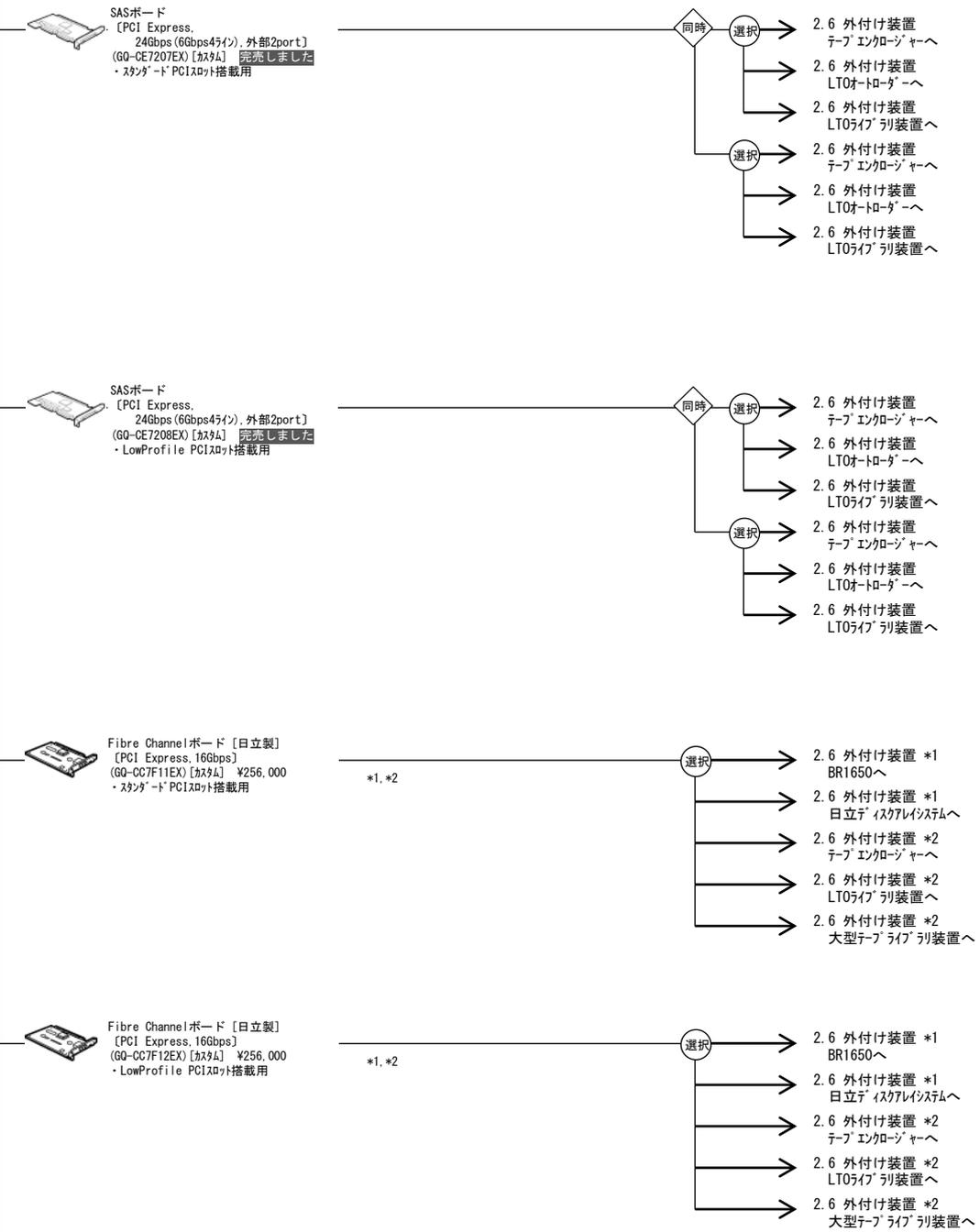
※1: 同一システム装置で BR1250 と、BR1650 及び日立ディスクアレイシステムの混在接続はできません。但し、BR1650 と日立ディスクアレイシステムの混在接続をサポートします。接続方法につきましては、「2.ハードウェア構成図 外付けオプション編」の各外付け装置の記載内容をご確認ください。
