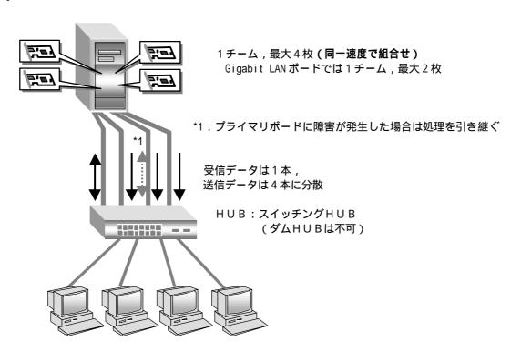
10/100M LAN ボード (最大 4 枚), もしくは Gigabit LAN ボード (最大 2 枚)で構成できます。 Gigabit LAN ボード と 10/100M LAN ボードを同一チームとして構成することはできません。装置標準搭載 10/100M LAN (オンボード LAN) は 10/100M LAN ボードと同じ扱いとなります。
