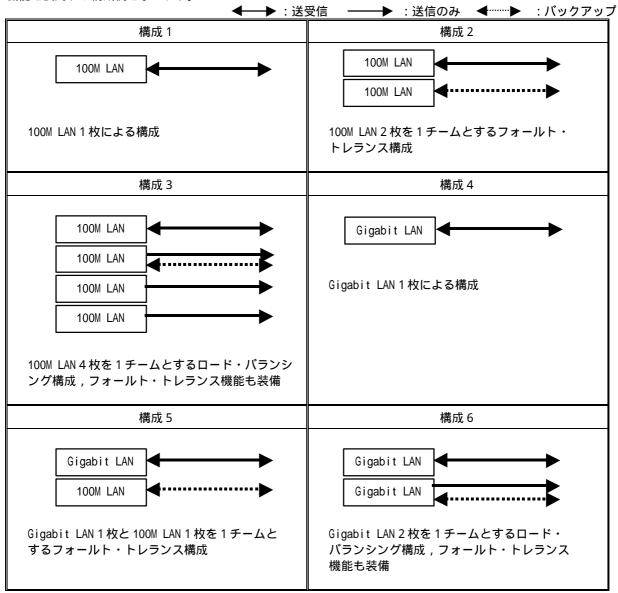
100M LAN: 10/100M LANボード GS-CN7240 および標準搭載 10/100M LAN(わボード LAN) Gigabit LAN: Gigabit LANボード GS-CN7540
