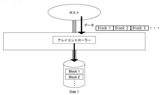
データは1台のハードディスクのみに格納されます。 データリダンダンシは行わず、一般的なコントローラーに接続されるハードディスクと同様の働きをします。
