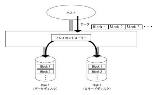
データは、1台のハードディスク(データディスク)と、もう1台のハードディスク(ミラードディスク) に同じように格納されます。
