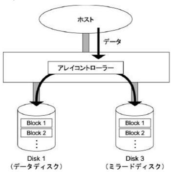
データは、一つのハードディスク(データディスク)と、もう一つのハードディスク(ミラードディスク)に同じように格納されます。
