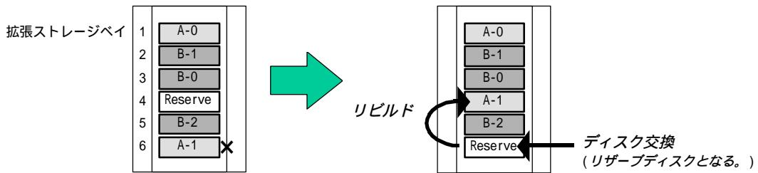
以上のホットスペアの結果、最初の構成と同じ位置にリザーブディスクがありますが、ディスクアレイのデータディスクは A-1 と B-1 が入れ替わってしまいます。つまり、ディスクアレイを構成するハードディスクは、どの位置にも入れ替わる可能性があります。
