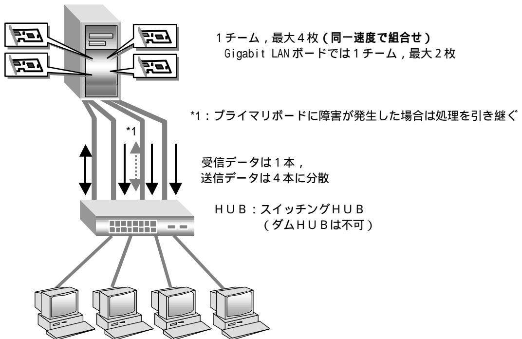
10/100M LANボード（最大4枚）、もしくはGigabit LANボード（最大2枚）で構成できます。Gigabit LANボードと10/100M LANボードを同一チームとして構成することはできません。装置標準搭載10/100M LAN（オンボードLAN）は10/100M LANボードと同じ扱いとなります。
