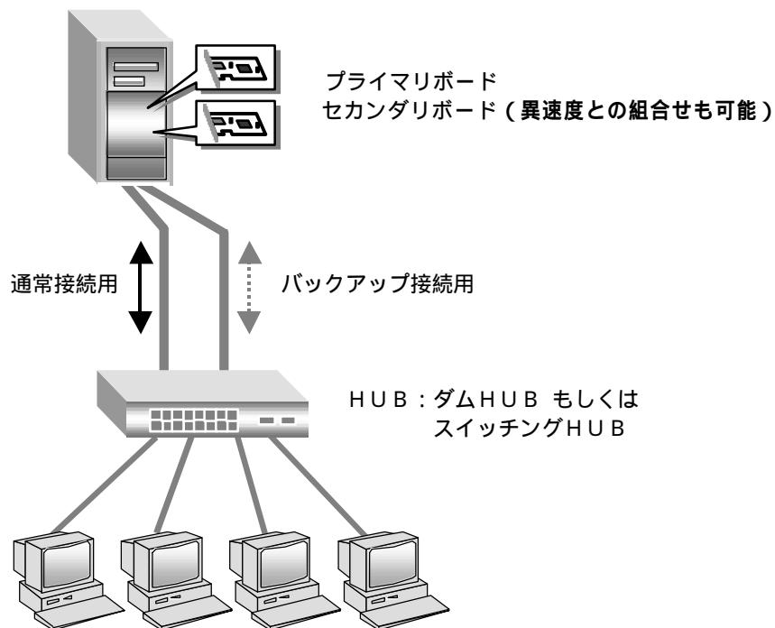
10/100M LANボード、Gigabit LANボードもしくはGigabit LANボードと10/100M LANボードの組合せで構成できます。また装置標準搭載10/100M LAN（オンボードLAN）は10/100M LANボードと同じ扱いとなります。
