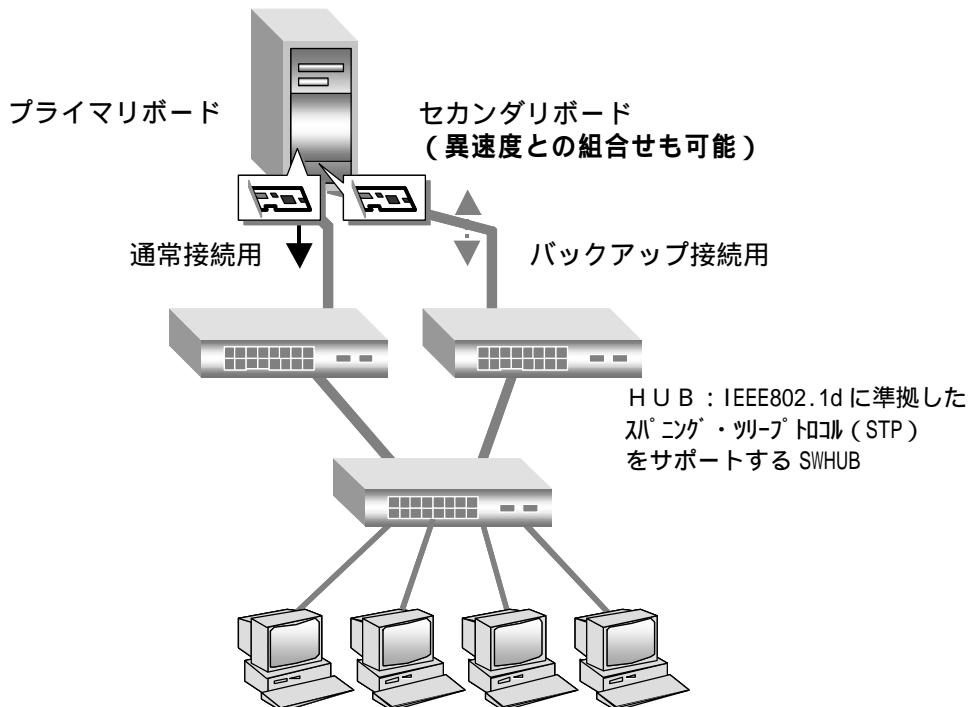
10/100M LAN ボード、Gigabit LAN ボードおよびGigabit LAN ボードと 10/100M LAN ボードの組合せで構成できます。異なる速度の LAN ボードとの組み合わせも可能です。また装置標準搭載の 10/100M LAN コントローラ（オンボード LAN）は 10/100M LAN ボードと同じ扱いに、装置標準搭載の Gigabit LAN コントローラは Gigabit LAN ボードと同じ扱いになります。
