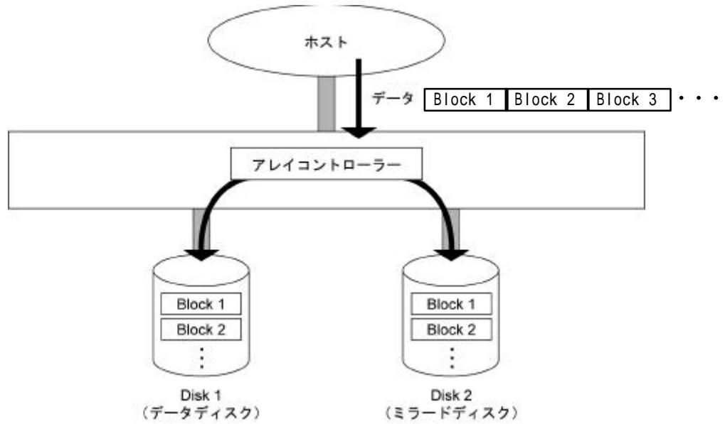
データは、1台のハードディスク（データディスク）と、もう1台のハードディスク（ミラードディスク）に同じように格納されます。
