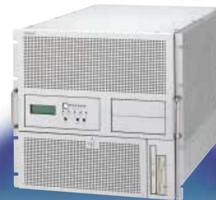
膨大なトラフィック処理に対応できる、最上位エンタープライズモデルです。Intel社Profusionアーキテクチャーに基づき日立が開発したチップセットにより、Intel® Pentium® Xeon™ プロセッサを最大8個まで搭載可能。メインメモリーは最大32Gバイト、ハードディスクは10,000回転/分の高速性を実現。また、PCIスロットは64bit x 12スロットで幅広い拡張性を確保しています。さらに、RAID内蔵やテラバイト級の大容量ディスクアレイのサポート、LANボードの二重化によって高可用性を追求。24時間365日眠らないビジネスを強力に支えるインフラとなります。筐体サイズは10U (ユニット) と高密度実装。ハーフラックに収納でき、フルラックには最大3台までシステム装置の収納が可能です。小型で大容量、高性能。銀行、証券などの大規模ネットワーク、大規模容量システムにおけるバックエンドサーバとして優れた処理能力を発揮します。
