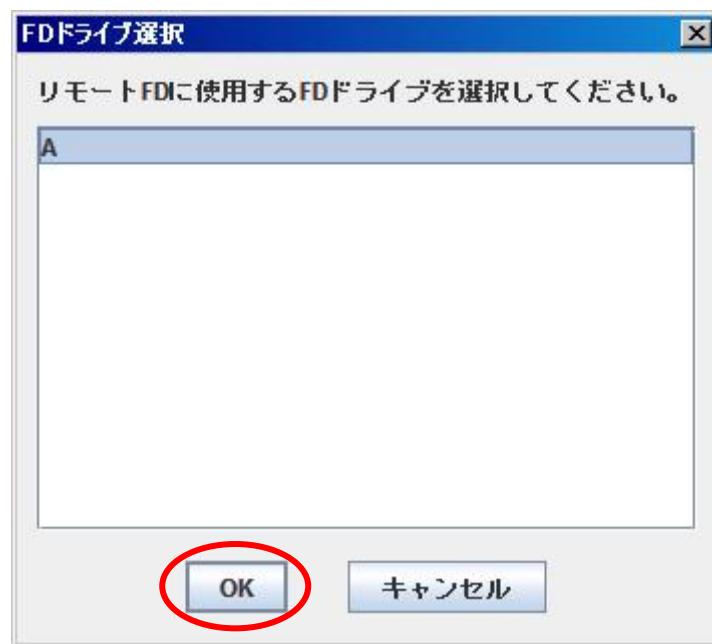
コンソール端末に搭載または接続されている FD ドライブがリモート FD としてシステム装置に接続されます。メディアをドライブに挿入して使用してください。
