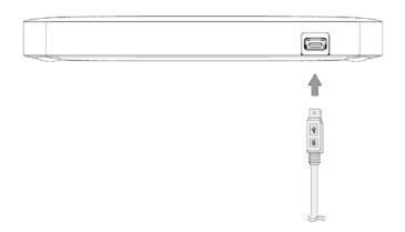
**2** システム装置前面、操作パネル上の USB コネクタ (USB A メス側) に、付属の USB ケーブル (USB A オス側) を接続します。
