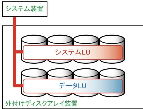
この構成例では、システムとデータの I/O 負荷が分散されます。
