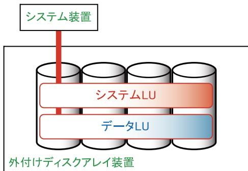
この構成例では、システムとデータが同一 RAID グループ上にあるため、データに高い I/O 負荷がかかる場合、アクセス競合により性能が劣化し、予期せぬ事態が発生するおそれがあります。また、ハードディスクの 2 重障害などが発生した場合、OS とデータが両方破損するおそれがあります。
