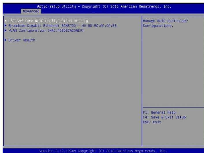
6 操作対象の「LSI Software RAID Configuration Utility」を選択し [Enter] キーを押します。
