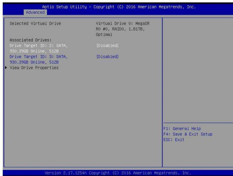
情報を参照する物理ドライブを [Enable] へ変更し、「View Drive Properties」を選択して [Enter] キーを押すと、物理ドライブのプロパティが表示されます。
