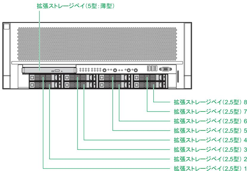
拡張ストレージベイ（2.5 型）とシステム装置前面のベイ表示は、次のとおり対応します。
