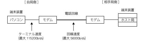
本 FAX モデムを MNP クラス 5 に設定している場合、ホスト局も MNP クラス 5 以上に対応していれば、モデム間で自動的にデータの圧縮をします。その結果、回線速度は 33600bps でも、実際には 33600bps 以上で通信を行ったことになります。通信をスムーズにするため、ターミナル速度は回線速度の  $2 \sim 3$  倍に設定してください。 回線速度とターミナル速度の通信速度差は、モデムのバッファで吸収します。なお、バッファがオーバーフローしないように、通信ソフトとモデムのシリアルポートでフロー制御の設定を行ってください。
