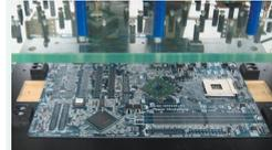
特別な試験装置を用いて全PCに対してメインボード上の回路の動作信号を確認します。
