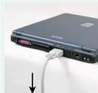
各種コネクターの挿し抜きを繰り返し、耐久性のチェックを行うとともに、ケーブルを大きな力で引っ張り、強度をチェックします。
