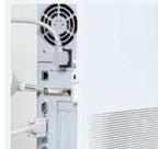
PC本体に静電気を加え、静電ノイズ耐性を確認します。
