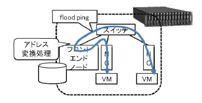
具体的には , ブレード A 上の VM1 からブレード B 上の VM2 に flood ping を打ち , その際のフロントエンドノードの CPU 使用率を測定した。
