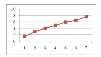
4.25packets/ms の処理を実行するたびに約 1%の CPU 使用率の上昇が観測された。通常それほど多量のパケット受信は発生しにくいことから,アドレス変換機構が性能に与える影響は微細と考えられる。
