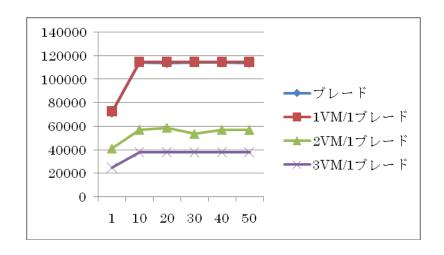
ファイルサイズが十分大きくなったことから,仮想化オーバヘッドの影響は微細となり,#1,2の結果はほぼ同等となった。一方,転送量が帯域の上限に達するようになったため,#2,3,4の間で性能差が生じるようになっている。
