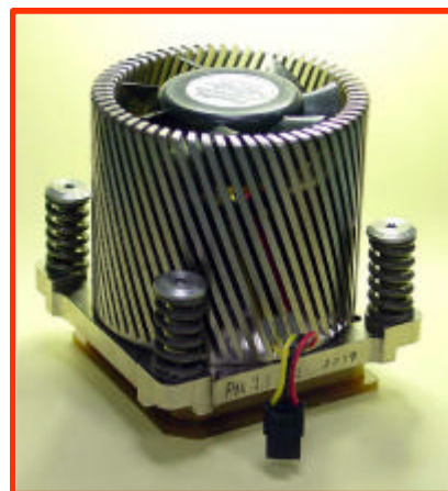
図 9. ターボ・クーリング・ファンによる冷却は、信頼性が非常に高く、静かで効率的です
