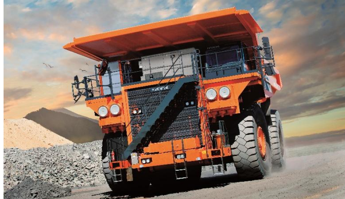
電気駆動式のリジッドダンプトラック EH4000AC-3
