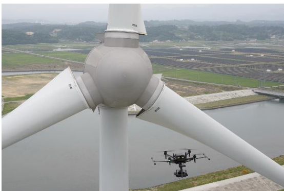
ドローンを用いたタワー点検のイメージ
