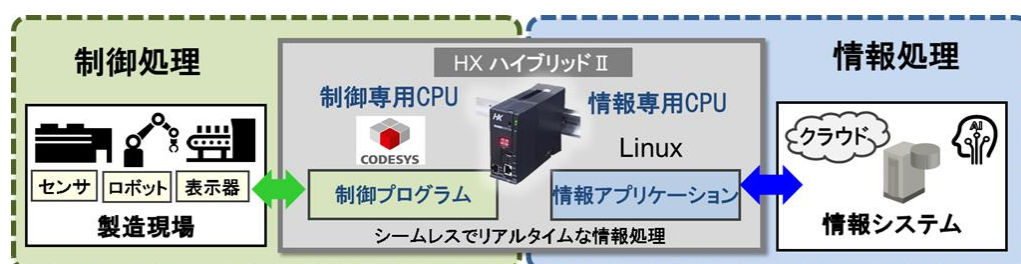
*CODESYS:国際標準規格(IEC61131-3)に対応した制御プログラミング言語 制御処理と情報処理の並列概念図
