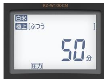
[図 6 ホワイトLED バックライト付き大型液晶]
