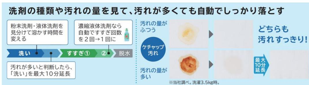
[図 3 洗剤・汚れセンサーシステム]
