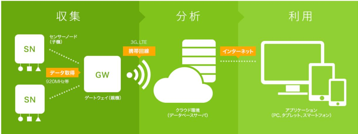
e-kakashi は、「カンタン」「手軽」「面白い」をコンセプトに開発された農業 IoT ソリューションです。田畑などの圃場（ほじょう）にセンサーネットワークを張り巡らせ環境情報や生育情報を収集し、営農支援向けに効果的に活用できます。また、圃場の温湿度や日射量、土壌内の温度や水分量、CO<sub>2</sub>などを計測できる各種センサーを搭載する子機からデータを収集し、通信モジュールを内蔵した親機を經由して、クラウド上で収集データを管理します。
