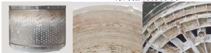
ステンレス槽外側の汚れ 外槽内側の汚れ ステンレス槽底面の汚れ
