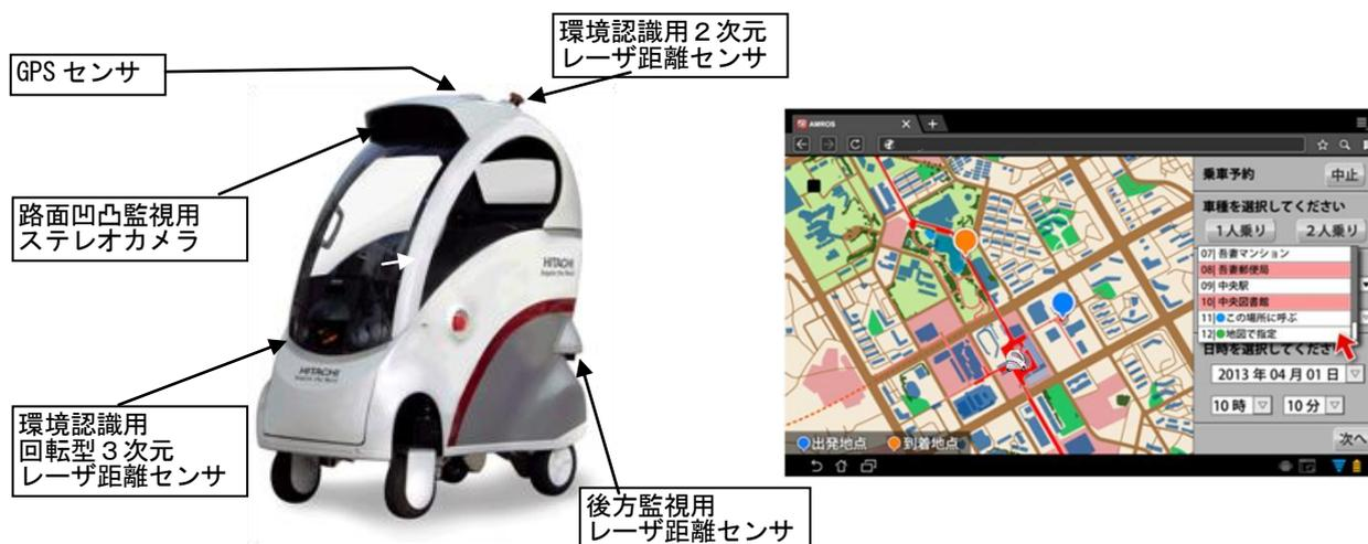
搭乗型移動支援ロボット「ROPITS」と、携帯端末予約用画面の例
