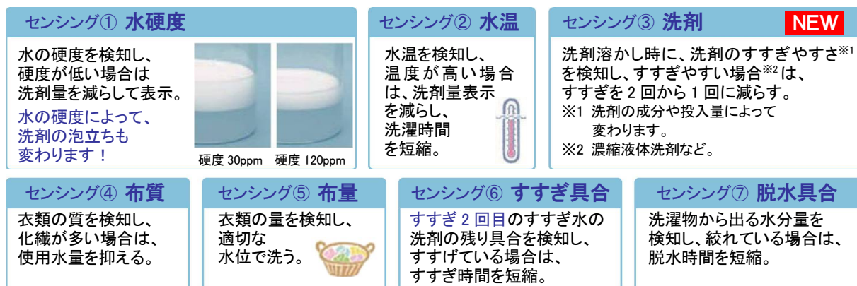
【図 11 「[eco]水センサー」システム】
