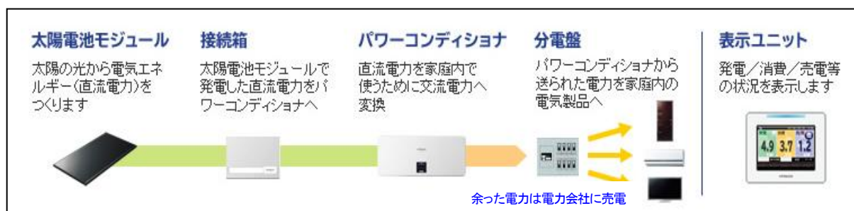
図. 一般的な住宅用太陽光発電システムの機器構成例
