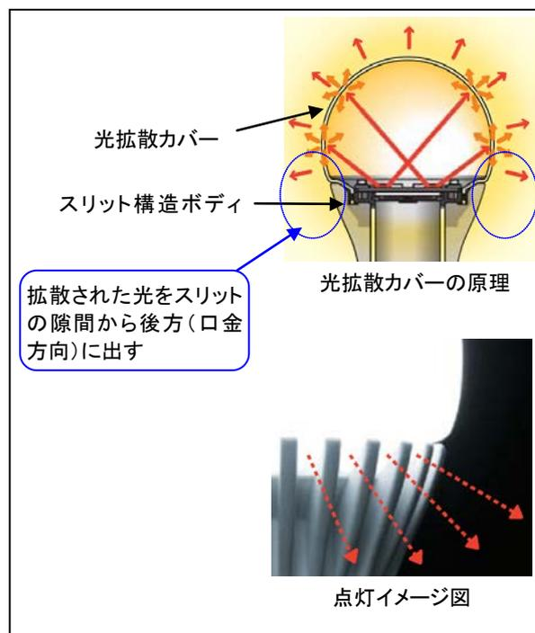
図 2. 光拡散カバーの原理と「スリット構造ボディ」からの光の広がり方
