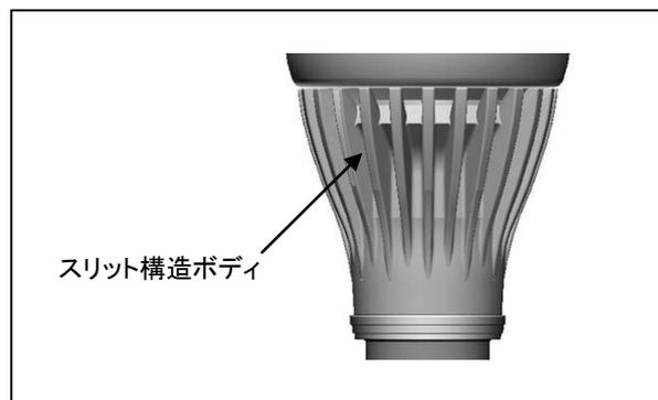
図 1. スリット構造ボディ
