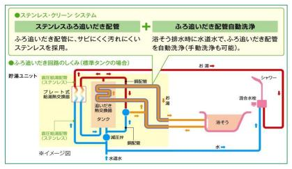
[図 7 ステンレス・クリーン システムのしくみ]
