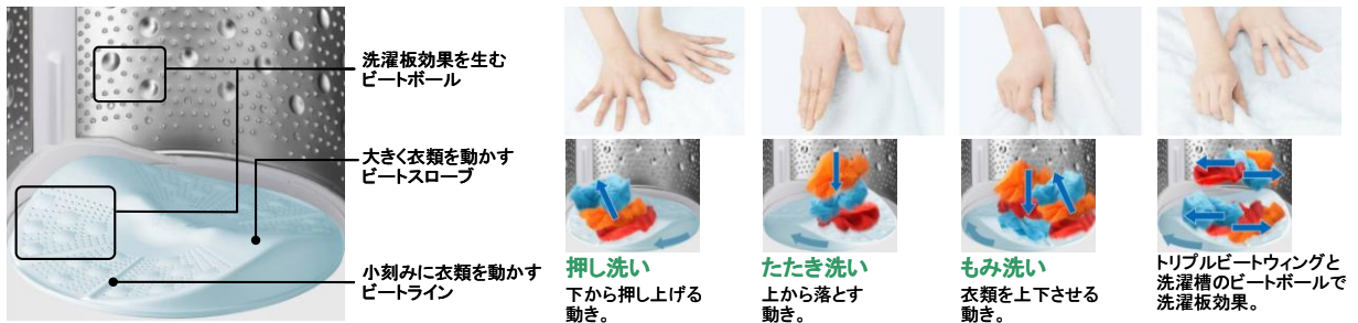
[図5 「ビートボール」を配した羽根・ステンレス槽と洗い方]
