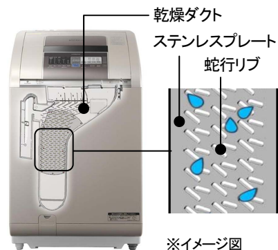
[図 3 「水冷除湿機構」]
