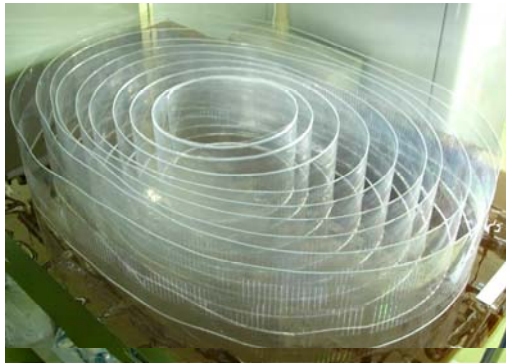
パターン転写したポリスチレンシート (転写長 15m)
