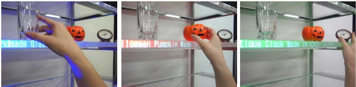
陳列棚の端面への情報表示と画像処理によるタッチセンサ機能
