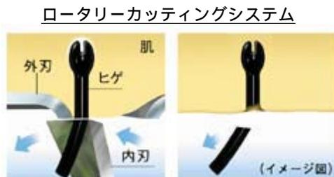
外刃でヒゲを押し出し、スパイラル刃の回転により、根元から横にスライスカットするので、深くキレイな断面に。
