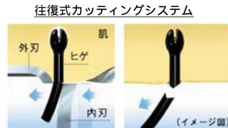
内刃がたわみ、外・内刃ではさみ切るなので、再カットの困難ないびつな断面に。
