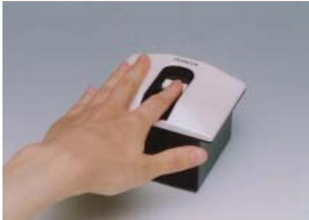
図：開発した開放型の指静脈認証装置(試作機)
