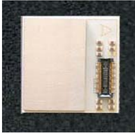
図：送受信モジュール断面構造と外観写真
