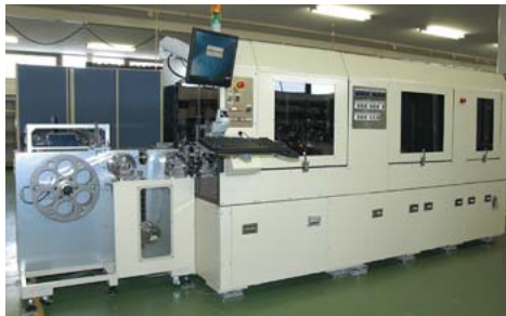
高速ICタグマシン UD-5000の特長 1時間あたり9,000個の高生産能力(9000UPH) 同一カメラでアライメント・検査を行うため、高精度を実現 フレイル加圧制御によりチップへのダメージを抑制 指静脈認証による操作部のセキュリティ強化
